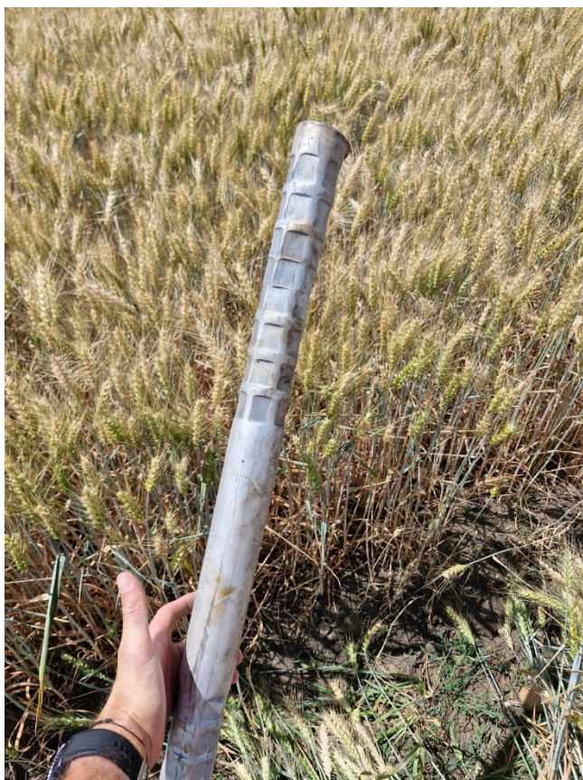
Obrázek 15 Fotografie konců přerušného lana vedení V411
